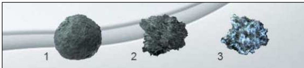
Activación Tribodinámica (TDA), cambia la superficie de las partículas de forma efectiva: 1. molienda clásica 2. Molienda jet (opuesta) 3. Molienda tribodinámica.
